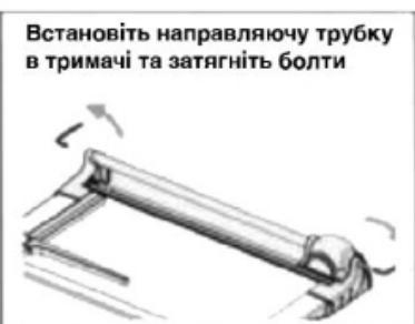
Встановіть направляючу трубку в тимчасі та затягніть болти
